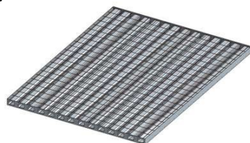
Figura 12: estrutura em perfil superior da estrutura da mesa de Laje Alveolar
