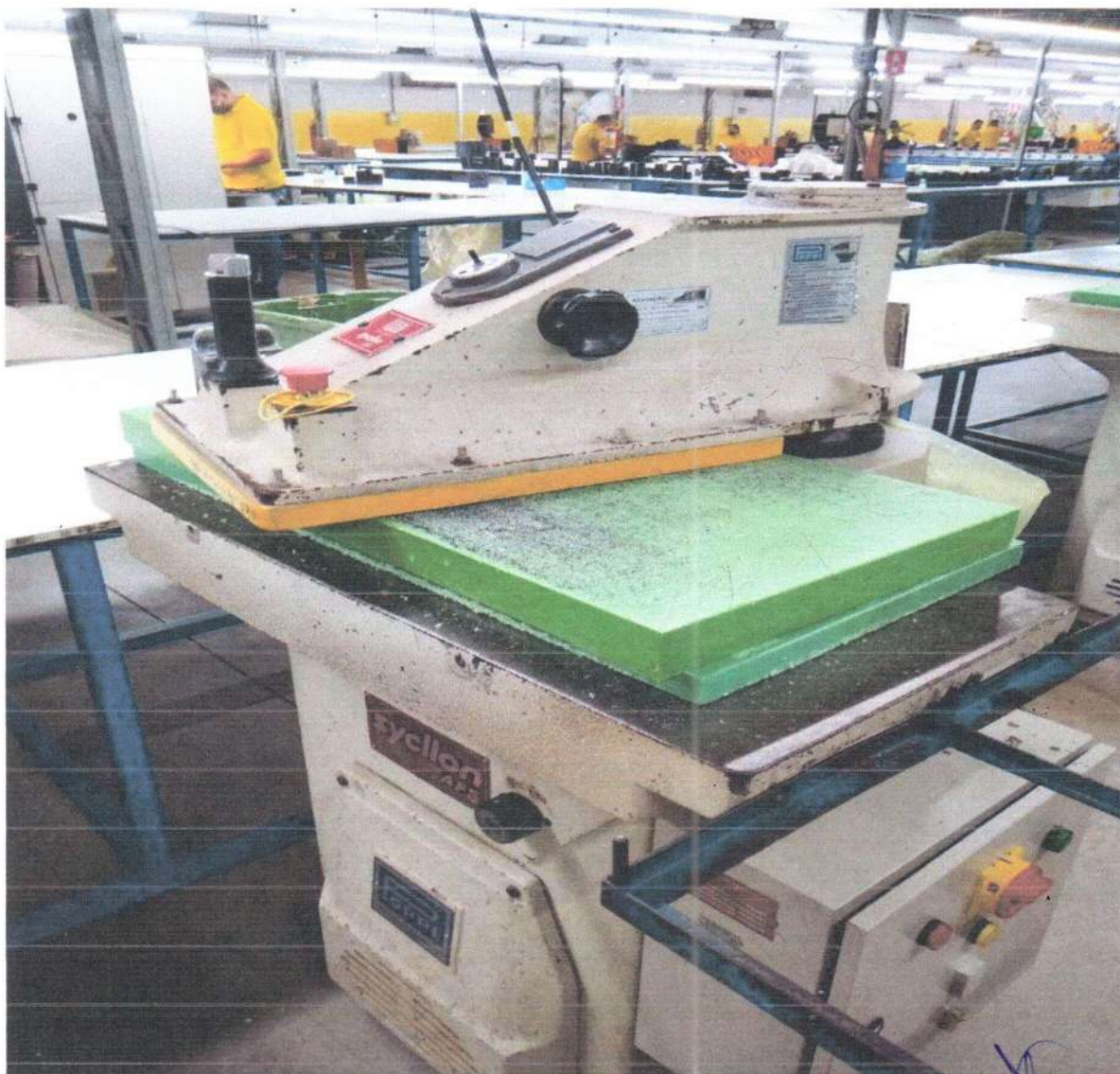
Foto 02 – Balancim (Prensa Hidráulica) para corte de calçados.
