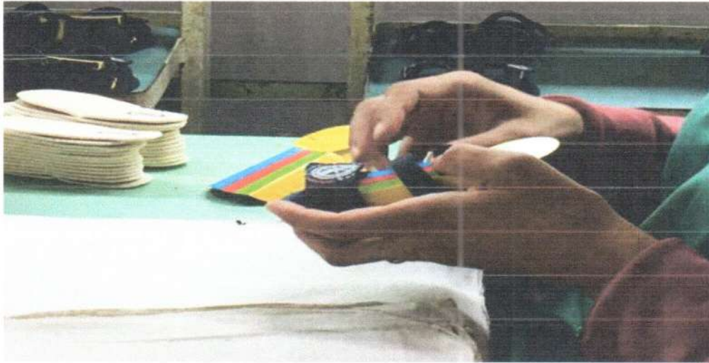
Foto 16 – Acabamento do calçado, introduzindo palmilha interna.
