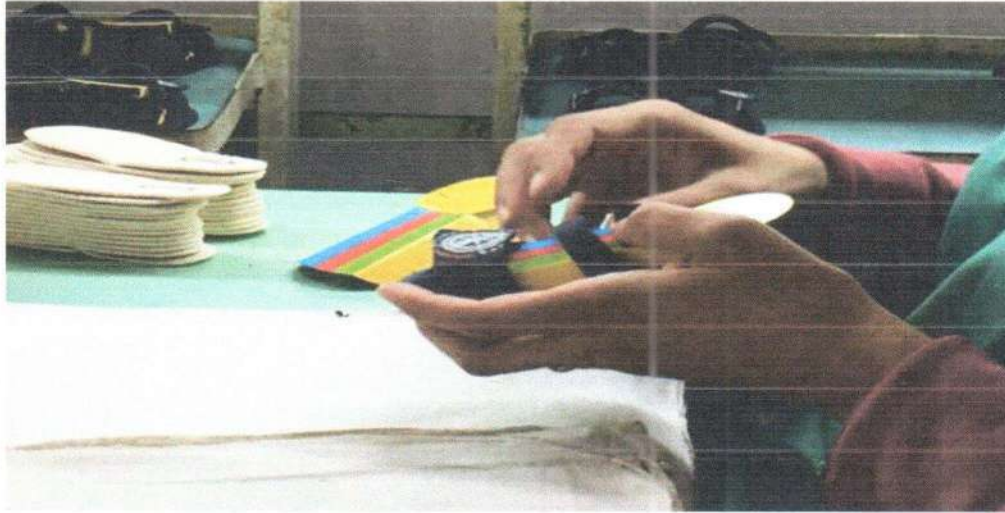
Foto 16 – Acabamento do calçado, introduzindo palmilha interna.
