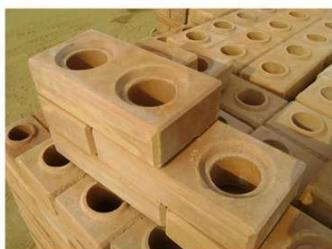
Figura 1 – Bloco de solo-cimento
