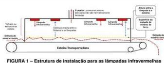
FIGURA 1 – Estrutura de instalação para as lâmpadas infravermelhas
