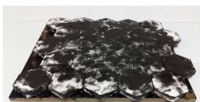
Figura 3 - Configuração final antes do teste balístico do sistema de blindagem multicamada.
