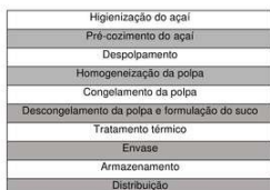
Figura 1. Fluxograma do processo de produção do suco do açaí (forma líquida)
