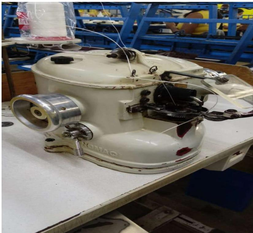
Foto 13 – Máquina de Montar o bico do calçado.
